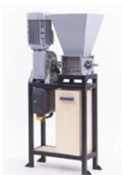
Slika 31. Stroj za recikliranje plastike, izdelan iz Dragocene plastike
