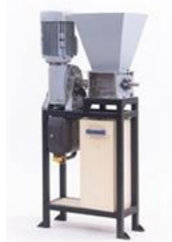
Εικόνα 31. Μηχανή κατασκευασμένη από Precious Plastics για την ανακύκλωση πλαστικών
