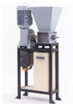
Slika 31. Mašina napravljena od dragocene plastike za reciklažu plastike
